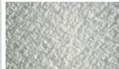
Briplast Finofill 1887 bei 20-facher Vergrößerung (ungeschliffen)
