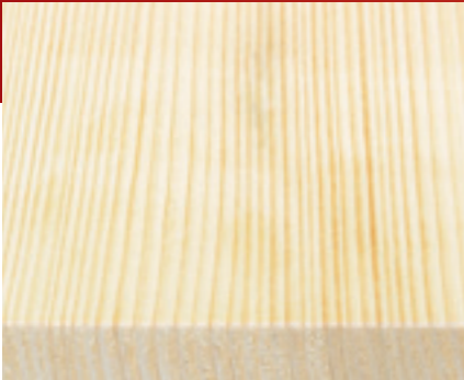
Radial- oder Spiegelschnitt
