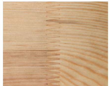
Für Fenster ungeeignete Keilverzinkung
