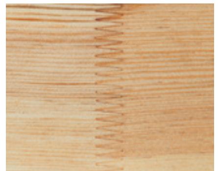
Für Fenster geeignete Keilverzinkung
